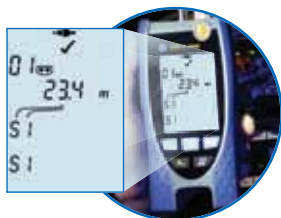
Тестирование коаксиального кабеля
